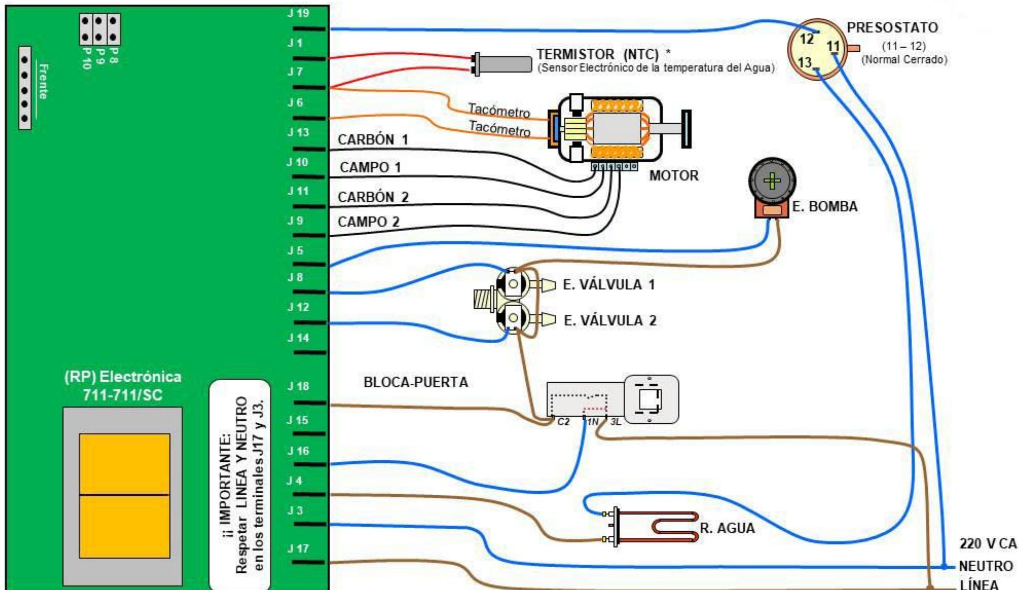
\*NOTA: En los casos de NO contar con SENSOR de temperatura NTC, NO utilizar el terminal J1, la placa corta el calentamiento del agua por TIEMPO. Si no utiliza la Resistencia de Calentamiento, dejar desconectado el terminal 13 del Presostato y J4 de la Placa.
