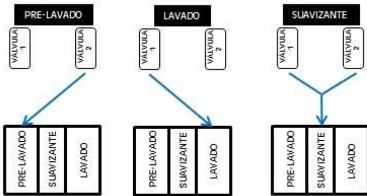
En el caso que el lavarropas NO POSEA los conductos en cruz de la jabonera, se deberá colocar un Jumper en el PIN P10, cambiando la dosificación de la siguiente manera:
